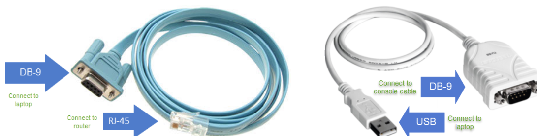
Obrázek 4.11: Vlevo: konzolový kabel RJ-45/DB-9, vpravo: redukce DB-9 na USB-A (Zdroj: https://dcloud-cms.cisco.com/help/connect_console )
