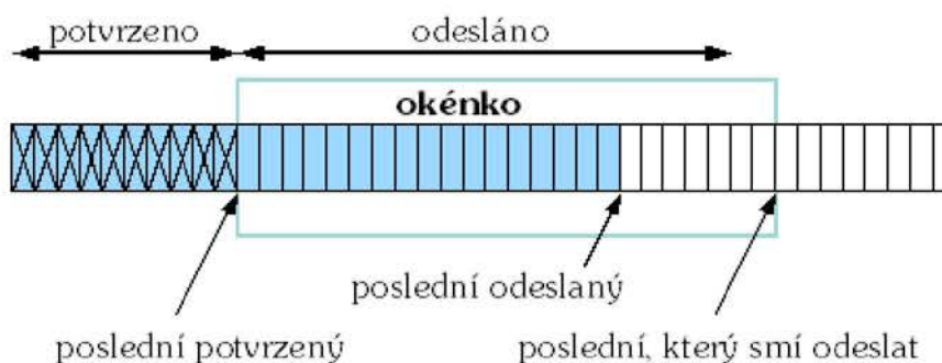
6.9 – Posuvné okénko (Sliding window) při TCP komunikaci
