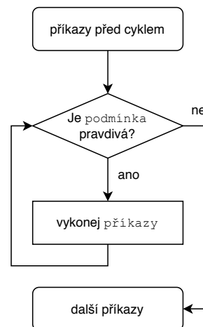
Obrázek 11: Grafické znázornění průběhu programu při vykonávání příkazu while .
